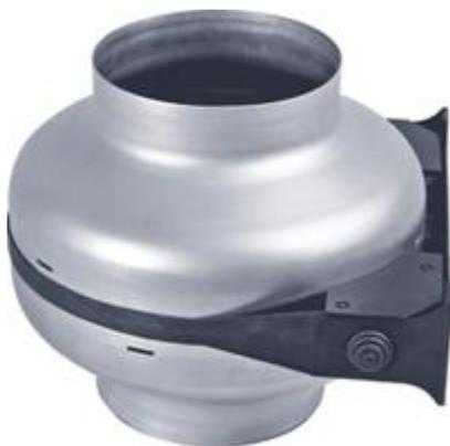
Канальные вентиляторы Turbo оборудованы асинхронным двигателем с внешним ротором и рабочим колесом с загнутыми назад лопатками. Корпус вентиляторов изготавливается из гальванизированной стали. Вентиляторы Turbo имеют типоразмеры от 100 до 315 мм и предназначены для соединения с воздуховодами круглого сечения. Степень защиты вентиляторов IP X4, клеммной коробки – IP 54.
